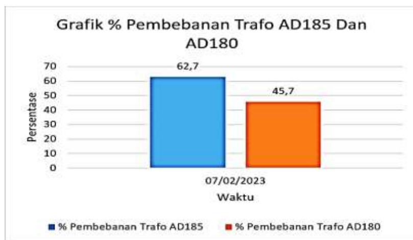
Gambar 4. Grafik Persentase Pembebanan Transformator AD185 Dan AD180
