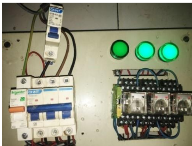
Gambar 3. Kondisi Rangkaian Rele Sederhana ketika Kehilangan Tegangan Satu Fasa
