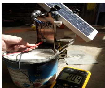
Gambar 4. Pengukuran tegangan dan arus sistem panel surya statis
