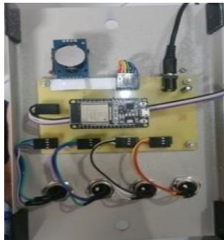
Gambar 4. Rangkaian weather station yang telah disusun
