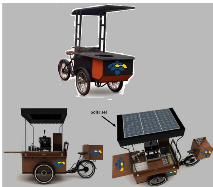
Gambar 5. Rancangan gerobak sepeda listrik untuk UMKM dengan metode self charging (SC)
