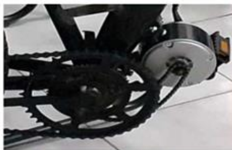
Posisi Motor DC sebagai Generator
